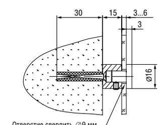
**L=15 мм, S=3-6 мм, D=16 мм**
