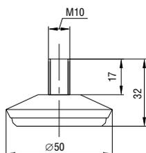
Позволяет производить регулировку в изделии по высоте в пределах 10 мм.
