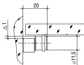
Используется для крепления полок внутри стеклянных конструкций с возможностью регулировки их в плоскости. Крепление к стеклу осуществляется с помощью УФ-отверждаемого клея.
