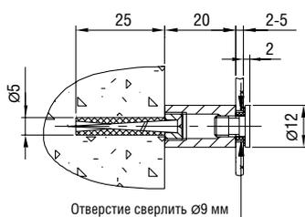
**L=20 мм, S=2-5 мм, D=12 мм**
