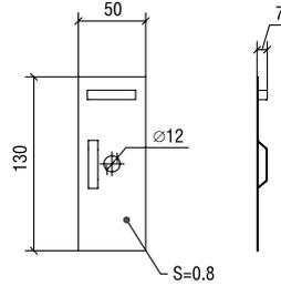
Предназначена для скрытого крепления зеркала к стене. Соединение пластины и зеркала осуществляется при помощи клеящих веществ. Отверстие позволяет крепить осветительное оборудование через пластину. Оцинкованная сталь.
