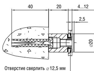
**L=20 мм, S=4-12 мм, D=20 мм**
