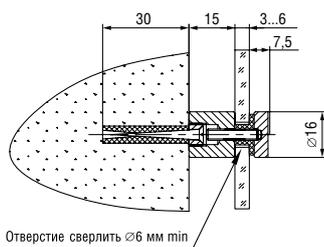
**L=15 мм, S=3-6 мм, D=16 мм**
