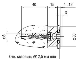
**L=15 мм, S=4-12 мм, D=30 мм**
