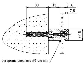
**L=15 мм, S=3-6 мм, D=16 мм**
