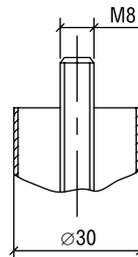
Диаметр трубы 30 мм, толщина стенки 1 мм.
