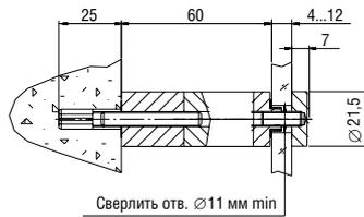
**L=60 мм, S=4-12 мм, D=22 мм**
