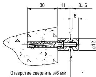
**L=10 мм, S=3-6 мм, D=12 мм**
