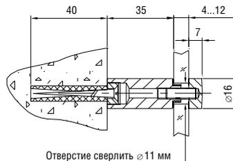
**L=35 мм, S=4-12 мм, D=16 мм**
