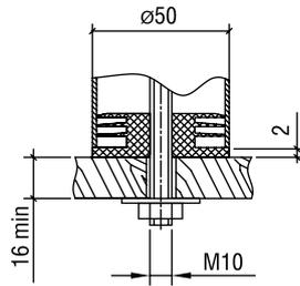
Используется для крепления на основе трубы диаметром 50 мм и толщиной стенки 1 мм к полке или карнизу из ДСП или массива. Пластик.
