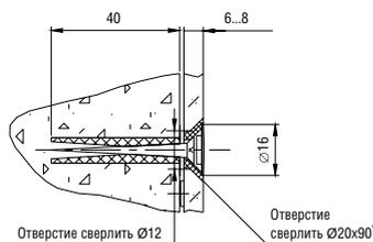
Держатель позволяет крепить вплотную к стене панели из стекла и акрила. При этом шляпка Держателя монтируется вровень (заподлицо) с поверхностью закрепляемого стекла и не выступает за ее пределы. Особенно актуальным данное изделие будет при монтаже стеклянных кухонных фартуков.
