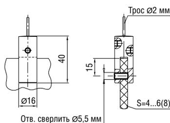
Отв. сверлить  $\varnothing 5,5$  мм
