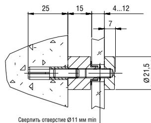
**L=15 мм, S=4-12 мм, D=22 мм**
