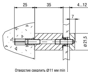
**L=35 мм, S=4-12 мм, D=22 мм**
