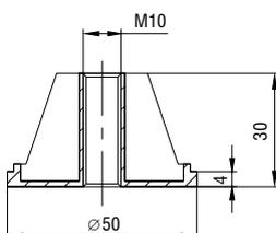
Используется в качестве завершающего звена при сборке на основе трубы диаметром 50 мм и толщиной стенки 1 мм.
