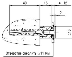
**L=15 мм, S=4-12 мм, D=16 мм**
