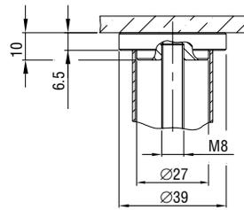
Используется для крепления столешниц из стекла при помощи УФ-отверждаемого клея.
