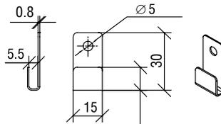
Предназначен для завешивания зеркал на стену с использованием Пластины Тип 1 оцинкованной или Пластины Тип 2 оцинкованной. Нержавеющая сталь.
