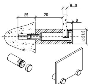
**L=20 мм, S=6-8 мм, D=22 мм**
