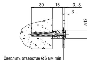
**L=15 мм, S=3-8 мм, D=12 мм**
