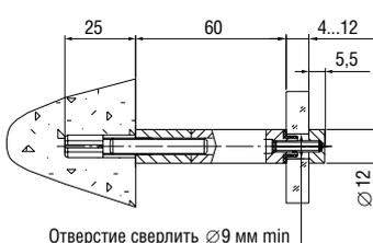
**L=60 мм, S=4-12 мм, D=12 мм**
