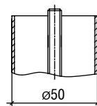
Диаметр трубы 50 мм, толщина стенки 1 мм.
