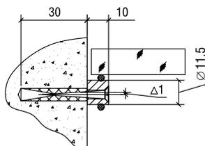
**Исполнение: 01** – никель. Используется для крепления полок в стеновых нишах с возможностью выравнивания в горизонтальной плоскости.
