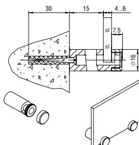
**L=15 мм, S=4-6 мм, D=16 мм**
