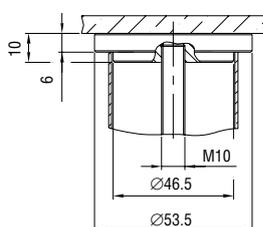
Используется для крепления столешниц из стекла при помощи УФ-отверждаемого клея. Сборка производится от опоры.
