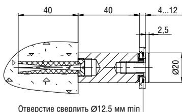
**L=40 мм, S=4-12 мм, D=20 мм**
