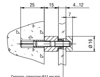
**L=15 мм, S=4-12 мм, D=16 мм**
