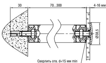
**L=70...300 мм, S=4-16 мм, D=39 мм**
