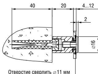
**L=20 мм, S=4-12 мм, D=16 мм**
