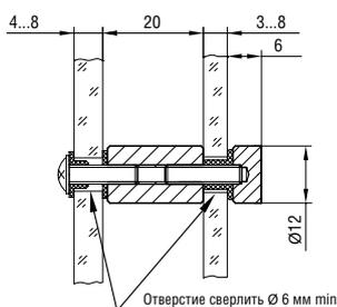
**L=20 мм, S=3-8 мм, D=12 мм**
