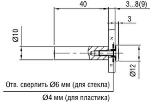
**L=40 мм, S=3-9 мм, D=12 мм**
