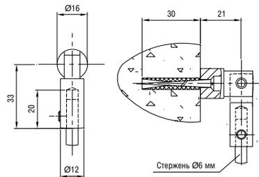
Предназначен для крепления стержня  $\varnothing 6$  мм к стене.
