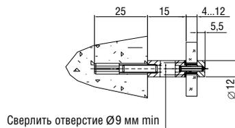
**L=15 мм, S=4-12 мм, D=12 мм**
