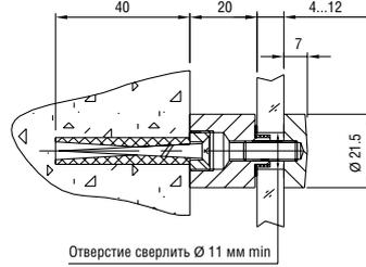
**L=20 мм, S=4-12 мм, D=22 мм**
