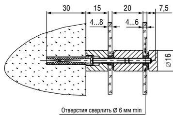
**L=15/20 мм, S=4-8/4-6мм, D=16 мм**
