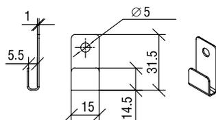
Предназначен для завешивания зеркал на стену с использованием Пластины Тип 1 оцинкованной или Пластины Тип 2 оцинкованной. Оцинкованная сталь.
