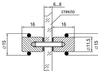
**Исполнение: 01** – никель, **04** – матирование, никель. Используется для крепления полок внутри стеклянных конструкций, имеющих несколько секций с перегородками.
