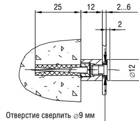
**L=12 мм, S=2-6 мм, D=12 мм**
