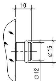
Используется в качестве амортизатора для стеклянной двери, а также для крепления полок внутри стеклянных конструкций.
