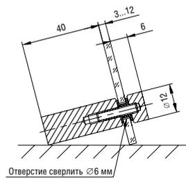
**L=40 мм, S=3-12 мм, D=12 мм**
