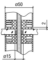
Используется для крепления полок из стекла или ДСП в конструкциях стойки на основе трубы диаметром 50 мм и толщиной стенки 1 мм.
