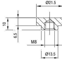
Предназначена для крепления столешниц из стекла при помощи УФ-отверждаемого клея.
