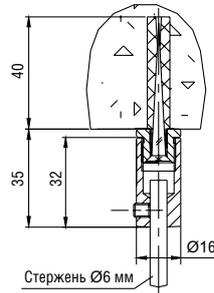
Используется для крепления стержня  $\varnothing 6$  мм к плоскости (полу, потолку).
