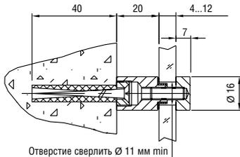
**L=20 мм, S=4-12 мм, D=16 мм**
