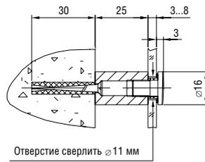
**L=25 мм, S=3-8 мм, D=16 мм**
