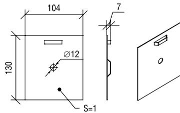
Предназначена для скрытого крепления зеркала к стене. Соединение пластины и зеркала осуществляется при помощи клеящих веществ. Отверстие позволяет крепить осветительное оборудование через пластину. Оцинкованная сталь.
