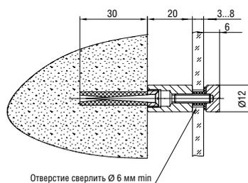
**L=20 мм, S=3-8 мм, D=12 мм**
