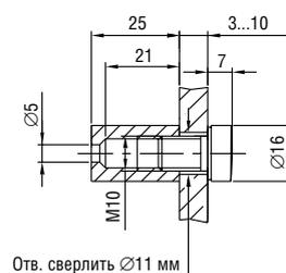
**L=25 мм, S=3-10 мм, D=16 мм**
