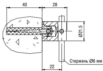
Используется для крепления стержня  $\varnothing 6$  мм к стене.
