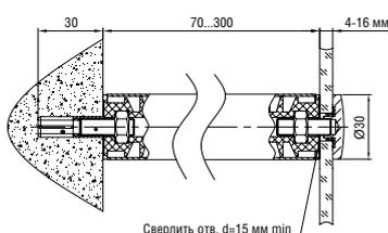
**L=70...300 мм, S=4-16 мм, D=30 мм**
