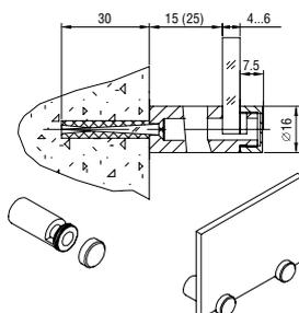
**L=15 (25) мм, S=4-6 мм, D=16 мм**
