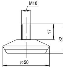
Позволяет производить регулировку в изделии по высоте в пределах 10 мм. Нагрузка 50 кг. Металл.
