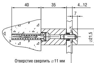
**L=35 мм, S=4-12 мм, D=22 мм**
