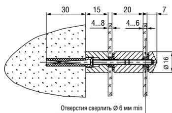
**L=15/20 мм, S=4-8/4-6мм, D=16 мм**
