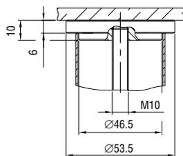
Используется для крепления столешниц из стекла при помощи УФ-отверждаемого клея. Сборка стойки производится от опоры.
