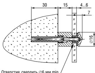
**L=15 мм, S=4-6 мм, D=16 мм**
