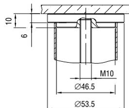
Используется для крепления столешниц из стекла при помощи УФ-отверждаемого клея. Сборка стойки производится от опоры.
