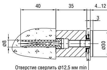
**L=35 мм, S=4-12 мм, D=30 мм**
