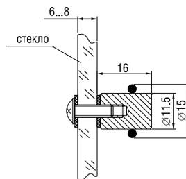
**Исполнение: 01** – никель, **04** – матирование, никель. Используется для крепления полок внутри стеклянных конструкций.
