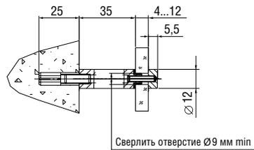
**L=35 мм, S=4-12 мм, D=12 мм**
