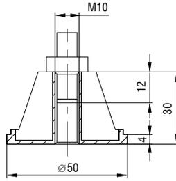
Используется в качестве завершающего звена при сборке на основе трубы диаметром 50 мм и толщиной стенки 1 мм с использованием заглушек. Сборка ведется снизу вверх. Металл.
