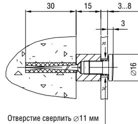
**L=15 мм, S=3-8 мм, D=16 мм**
