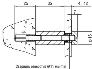
**L=35 мм, S=4-12 мм, D=16 мм**
