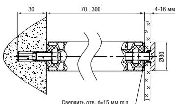
**L=70...300 мм, S=4-16 мм, D=30 мм**
