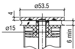
Используется для крепления столешниц из стекла или ДСП в конструкции на основе трубы диаметром 50 мм и толщиной стенки 1 мм. Отверстие в столешнице не менее 15 мм.
