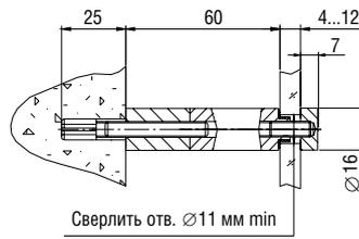
**L=60 мм, S=4-12 мм, D=16 мм**
